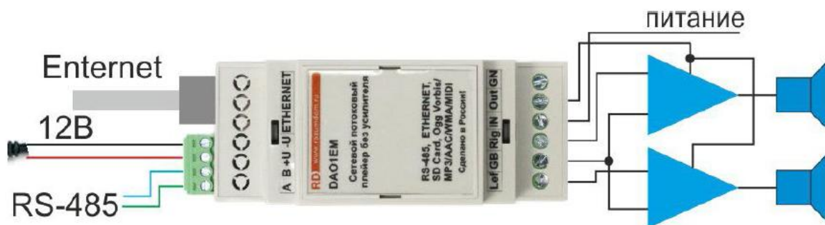
Рисунок 2.7.- Загальний вид модуля DAO1EM (18)
